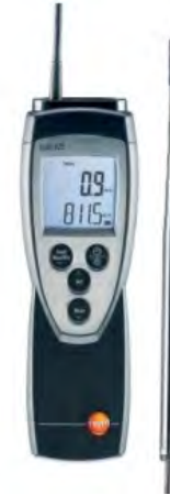
Измерительный элемент (зонд) – обогреваемая струна
