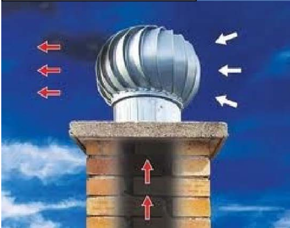
Рис. 7.3. Подсасывающее действие в зоне выходов удаляемого воздуха: FO – удаляемый (сбросной) воздух, АВ – вытяжной (уходящий) воздух
