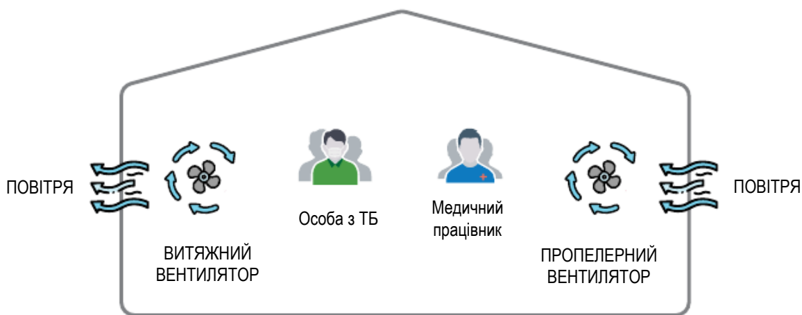
Рисунок 12. Належне розташування витяжних і пропелерних вентиляторів
